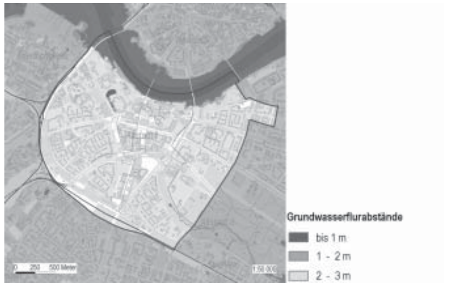
Abb. 5: Verbleibende Gefährdung durch Grundhochwasser
